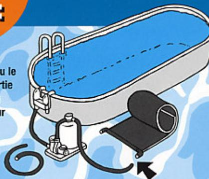
Raccordez le tuyau le plus long à la sortie du capteur solaire et au refoulement de votre piscine.
